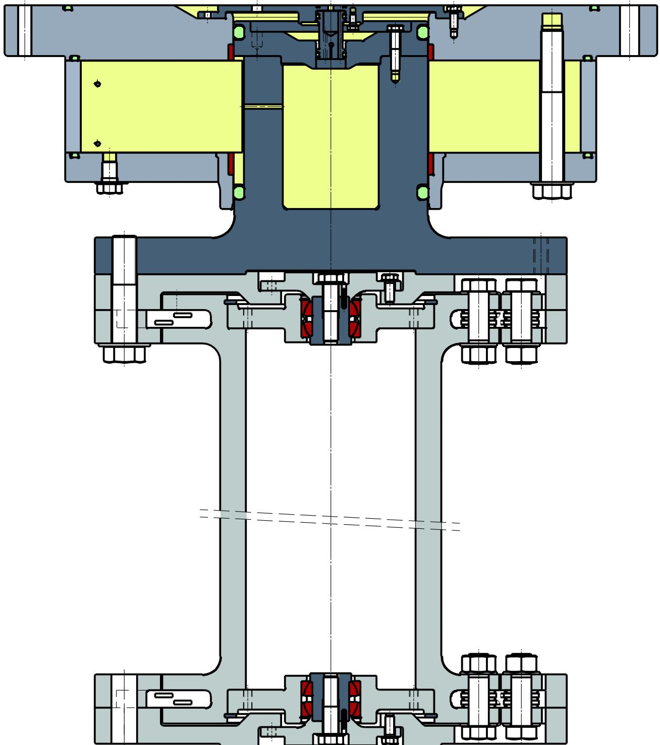
■ Geislinger BC Coupling + Geislinger Flexlink T6 + flangehub
